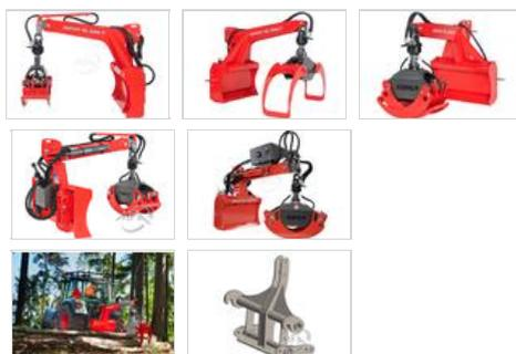
Le grappin de débardage est un outil alternatif au treuil, il permet de récupérer les morceaux de bois accessibles et évite au chauffeur de descendre du tracteur pour accrocher la grume. La pince serre la grume et la rotation permet de faciliter le débardage ainsi que la manutention.
